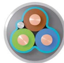
Bei geschirmten Installationskabeln ist zur Abschirmung der elektrischen Wechselfelder eine Aluminiumfolie um die Adern gewickelt. Ein blanker Schirmbeidraht (SB) ist zur Kontaktierung der Folie mit eingearbeitet. Beim Abmanteln der Kabel die Aluminiumfolie mit entfernen. Die Schirmbeidrähte und die grün-gelben Adern (PE) **getrennt** auf die jeweiligen Sammelschienen anschließen, sonst Kabel wie gewohnt verdrahten.
