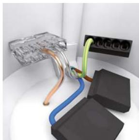
Bei geschirmten Gerätedosen keine ungeschirmten Kabel verwenden!
